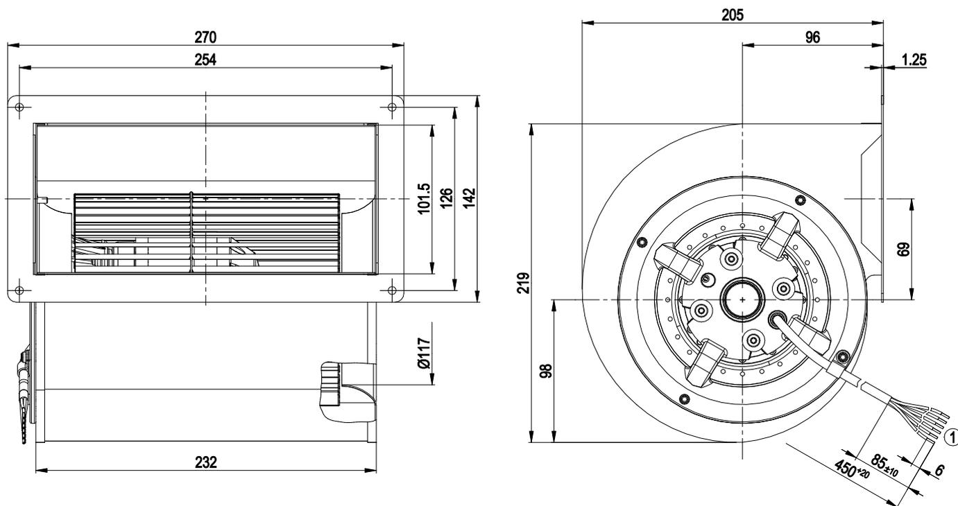
1 Соединительный кабель, силиконовый, 6G 0,5 мм<sup>2</sup>, 6 присоединенных кабельных наконечников
