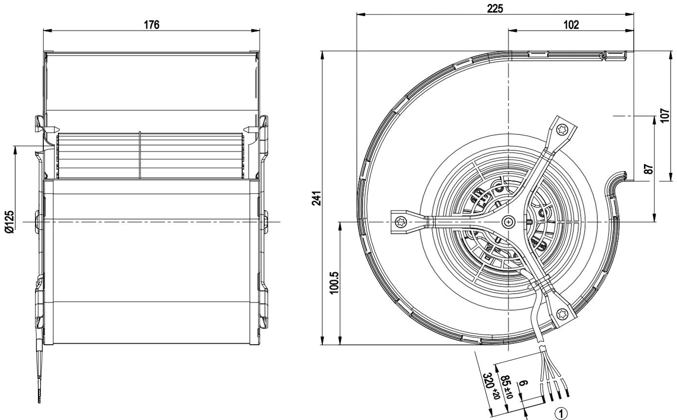
1 Соединительный провод, ПВХ, 4G 0,5 мм<sup>2</sup>, с заделкой 4 зажимами
