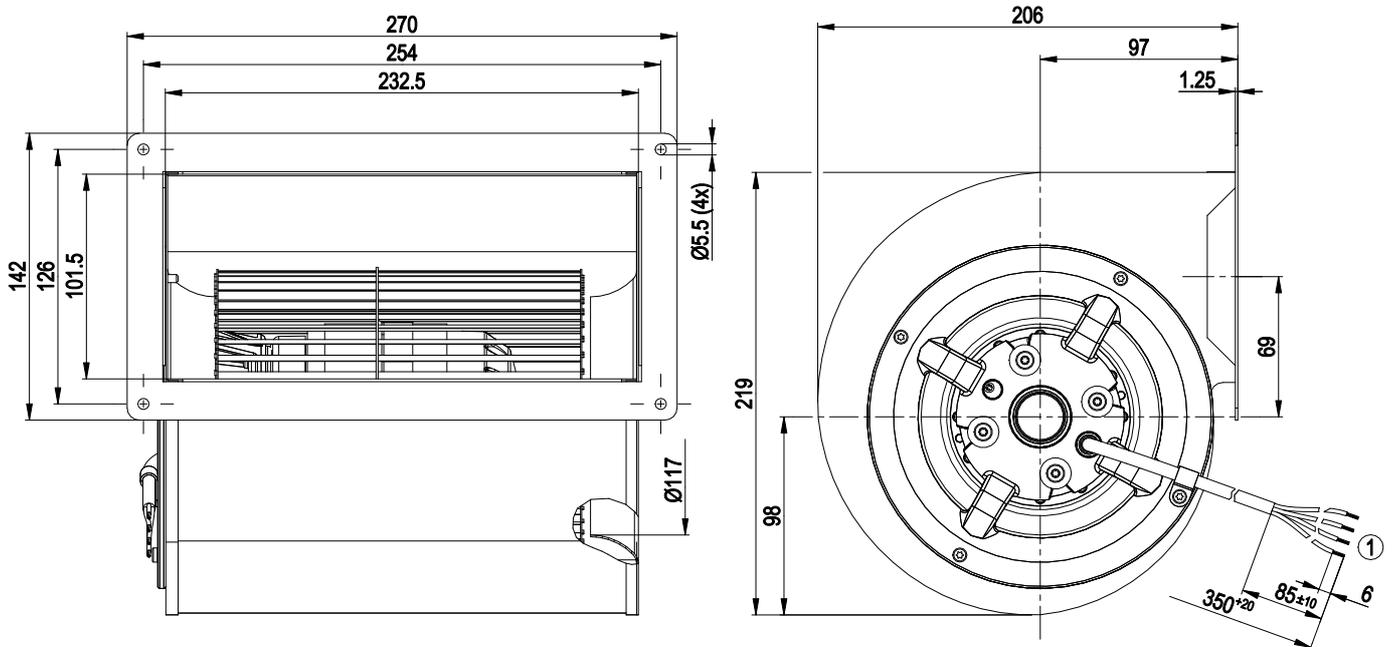
1 Соединительный кабель, силиконовый, 4G 0,5 мм<sup>2</sup>, 4 присоединенных кабельных наконечника
