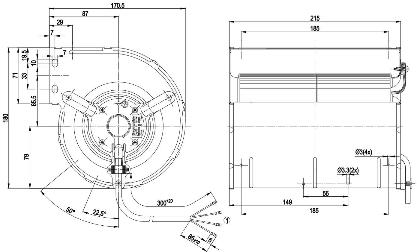
1 Соединительный кабель ПВХ 4G 0,5 мм<sup>2</sup>, 4 присоединенных кабельных наконечника
