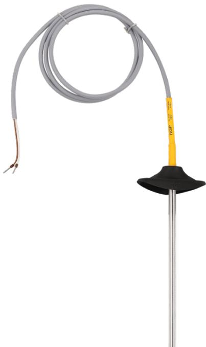
Датчики температуры RGP серии TU-K-01(02,03)-C служат для измерения температуры в воздуховодах, вентиляционных установках, также могут быть использованы для измерения температуры жидкости (при применении погружной гильзы). Могут применяться в любых условиях - степень защиты IP65.
