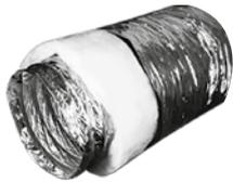
Гибкие тепло- и звукоизолированные воздуховоды с синтепоном. Внутренний воздуховод ZF с микроперфорацией, выполнен из алюминиевой фольги, ламинированной полиэфирной лентой, теплоизолирован слоем стекловаты и снабжен защитной оболочкой из металлизированной полиэфирной ленты..
