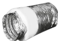
Гибкие теплоизолированные воздуховоды с синтепоном. Внутренний воздуховод ZF, теплоизолирован слоем синтепона и снабжен защитной оболочкой из металлизированной полиэфирной ленты.
