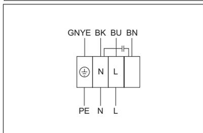
**Электрическая схема No. 3 (1~230В)**
