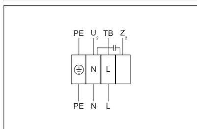
**Электрическая схема No. 4 (1~230В)**
