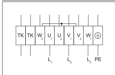
**Электрическая схема No. 2 (Y - 3~400В)**
