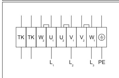
**Электрическая схема No. 2 (Δ - 3~230В)**
