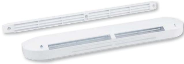
Гигрорегулируемые приточные клапаны с переменным расходом воздуха от 6 до 45 м³/ч (в зависимости от уровня влажности в помещении) при 20 Па. Подобное регулирование производительности позволяет сократить потери тепла при вентиляции помещений. С внутренней и наружной сторон помещения на клапане располагаются шумопоглощающие вставки. Приточные клапаны предназначены для установки на оконных рамах.
