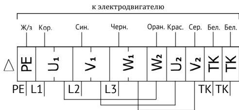
Схема 4. Подключение двигателя вентилятора RL80-50-6DN к электросети
