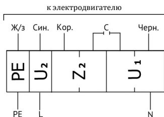
Схема 3. Подключение трехфазных двигателей вентиляторов к электросети (кроме вентилятора RL80-50-6DN)
