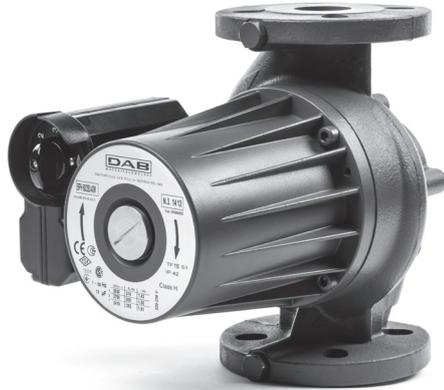
Насос для циркуляции горячей воды в небольших закрытых (с повышением давления) или открытых частных и промышленных системах отопления. Чугунный корпус и двигатель с мокрым ротором. Корпус электродвигателя из литого под давлением алюминия. Фланцевые соединения насосов имеют резьбовые отверстия для подключения манометров или контрольных датчиков.
