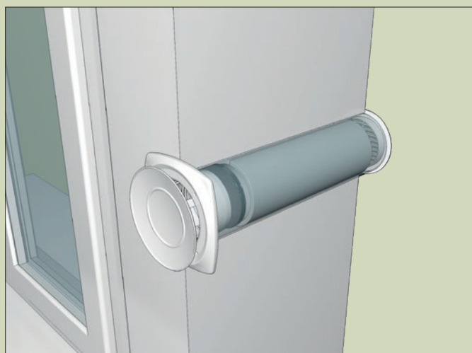
Типовой пример монтажа приточного клапана в стене
