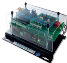
Устройства применяются как регуляторы мощности для управления промышленными установками (вентиляторами, насосами, лампами, и т.д.). Благодаря надежному и компактному построению обеспечивается управление с высоким КПД.
