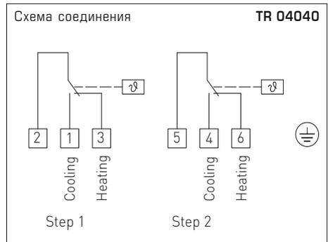
**THERMASREG® TR 04040 – Терморегулятор, двухступенчатый**
